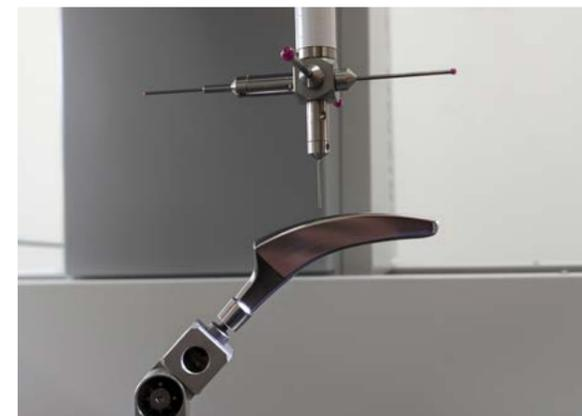
Hochpräzise Endkontrolle auf der 3D-Koordinatenmessmaschine Zeiss
